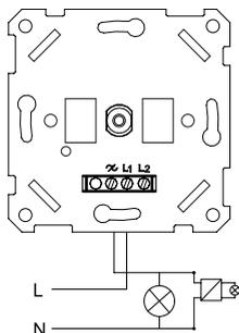
Винтовые зажимы для проводников сечением до 2,5 мм<sup>2</sup>.
