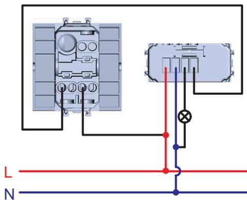
Схема подключения датчика движения с возможностью отключения.
