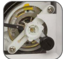
Настройка нулевого положения стрелки
